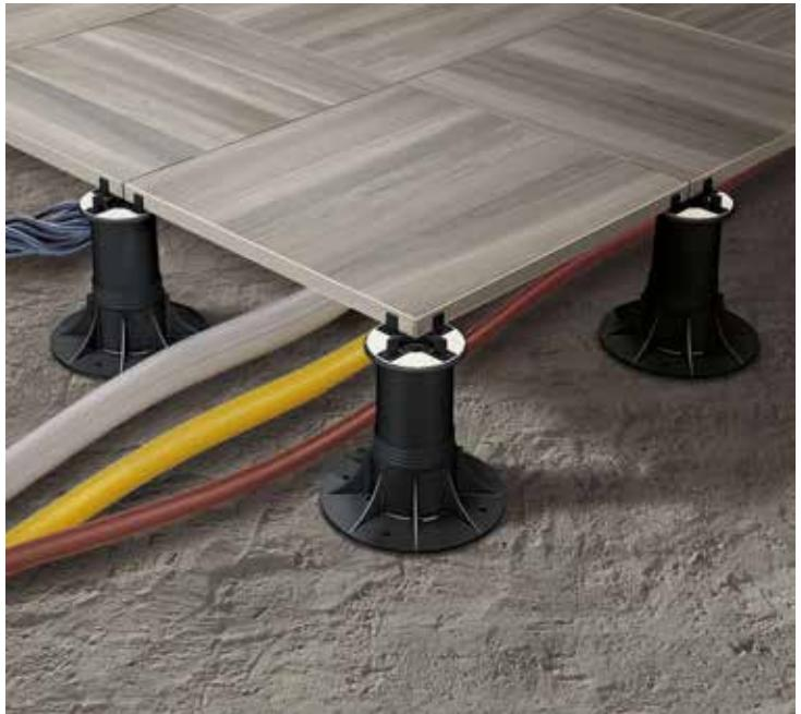
La posa sopraelevata è ottimale per ogni necessità di pavimentazione in presenza di cavi o tubi non inseriti nel massetto e per ogni necessità di ispezionabilità degli stessi o del sottobordo, inoltre garantisce il drenaggio delle acque piovane nelle pavimentazioni esterne.
